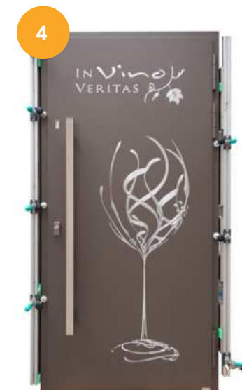
Finální testování hotových dveří ve zkušebním stojanu
